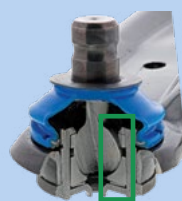
PARTES INTERNAS DE LA JUNTA ESFÉRICA MEJORADAS Los rodamientos sinterizados autolubricantes engrasables sobresalen en condiciones de alto calor y alta carga
