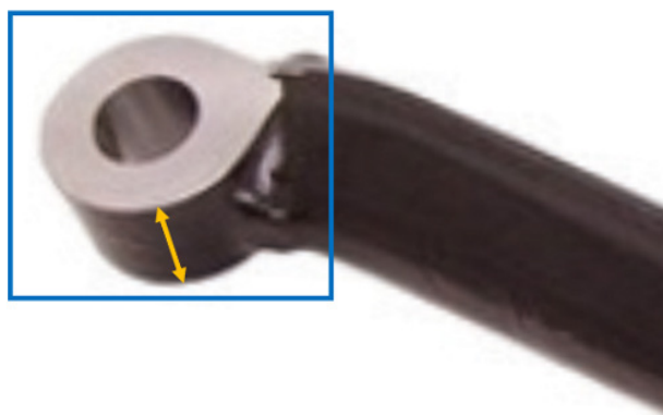
Figura 1. Brazo de control delantero inferior hacia adelante de cuello "delgado" de primer diseño
