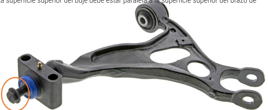
Figura 1. El perno del buje (encerrado en un círculo arriba) debe apretarse correctamente después de colocar el brazo de control en el vehículo
