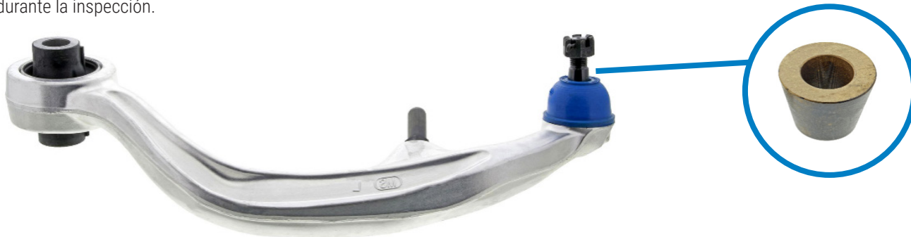
Figura 1. La camisa cónica (dentro del círculo) puede quedar adherida a la porción de la junta esférica del brazo de control usado y causar una diferencia visual cuando se compara con la nueva parte de reemplazo. Los brazos de control delanteros inferiores hacia atrás CMS30165 y CMS30166 Supreme de Mevotech tienen un recubrimiento anticorrosivo para reducir la posibilidad de adherirse.
