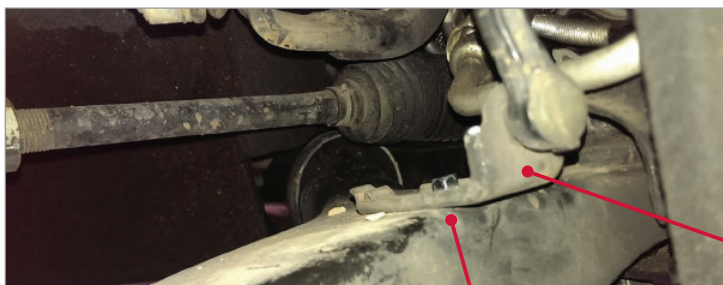
Figure 1 : Rivet à sertir en place dans le bras, créant un point de montage pour le boulon
