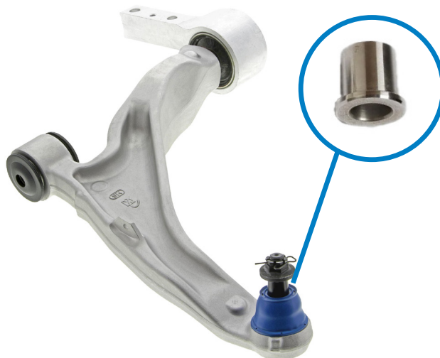
Figura 1. La camisa del muñón de dirección (dentro del círculo) puede quedar adherida al perno esférico y causar una diferencia visual cuando se compara con la nueva parte de reemplazo. Los conjuntos de brazo de control Supreme de Mevotech cuentan con un perno esférico con recubrimiento anticorrosivo para reducir la posibilidad de quedar adheridos.
