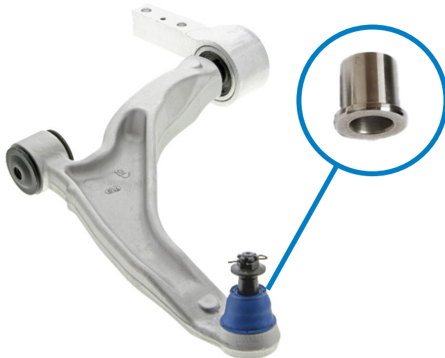
Figura 1. La camisa del muñón de dirección (dentro del círculo) puede quedar adherida al perno de la junta esférica y causar una diferencia visual cuando se comparan con la nueva parte de reemplazo. Los conjuntos de brazo de control Supreme de Mevotech cuentan con un perno esférico con recubrimiento anticorrosivo para reducir la posibilidad de quedar adheridos.
