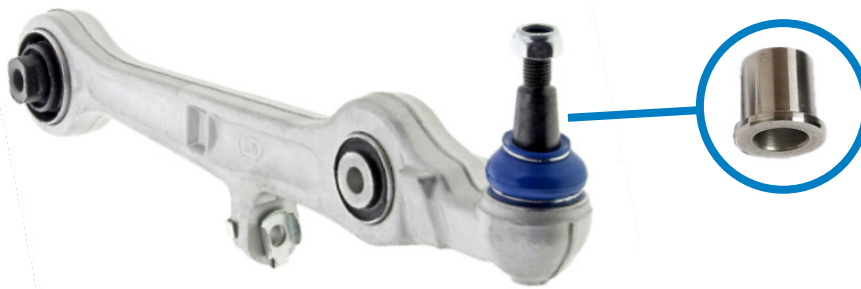
Figura 1. La camisa cónica del muñón de dirección (dentro del círculo) puede quedar adherida al perno de la junta esférica y causar una diferencia visual cuando se compara con la nueva parte de reemplazo. Los conjuntos de brazo de control Supreme de Mevotech cuentan con un perno esférico con recubrimiento anticorrosivo para reducir la posibilidad de quedar adheridos.
