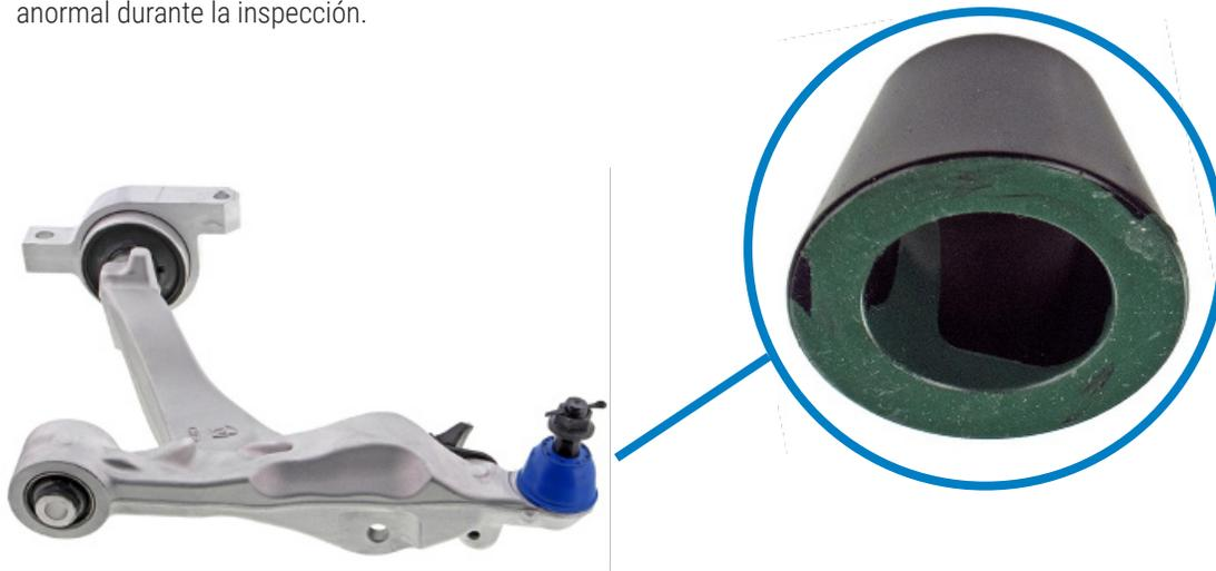
**Figura 1.** Cono de apoyo de la junta esférica típico de Nissan e Infiniti (dentro del círculo). Este cono puede quedar adherido al perno de la junta esférica y causar una diferencia visual cuando se compara con el brazo de control de reemplazo nuevo.
