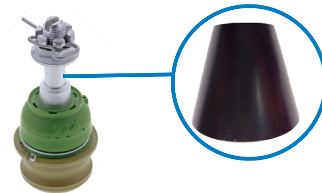
Figura 1. El cono de asentamiento de la juntas esférica (dentro del círculo) puede quedar adherido al perno de la junta esférica y causar que parezca diferente a la parte Mevotech. Las juntas esféricas de reemplazo Mevotech con los números de parte TXK9513/MK9513/GK9513 tienen un perno esférico con recubrimiento anticorrosivo para reducir la posibilidad de quedar adheridas.
