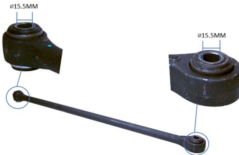
Figura 1. Barra transversal con ojales para perno de 15.5 mm de diámetro
