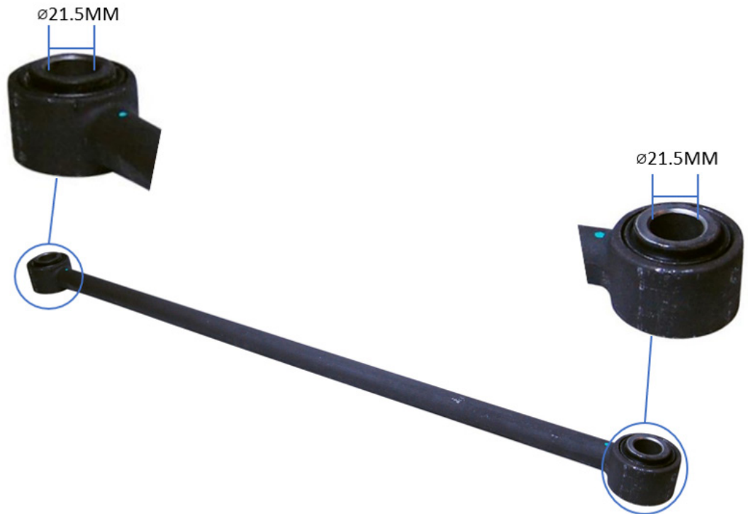
Figura 2. Barra transversal con ojales para perno de 21.5 mm de diámetro
