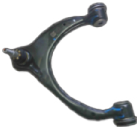
Figura 2. Diseño de acero estampado hueco
