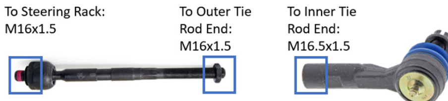
Figura 2. Si se requieren componentes de M16, use los siguientes extremos de reemplazo de la barra de acoplamiento interna y externa Supreme de Mevotech después de confirmar la versión y el paquete del vehículo:
