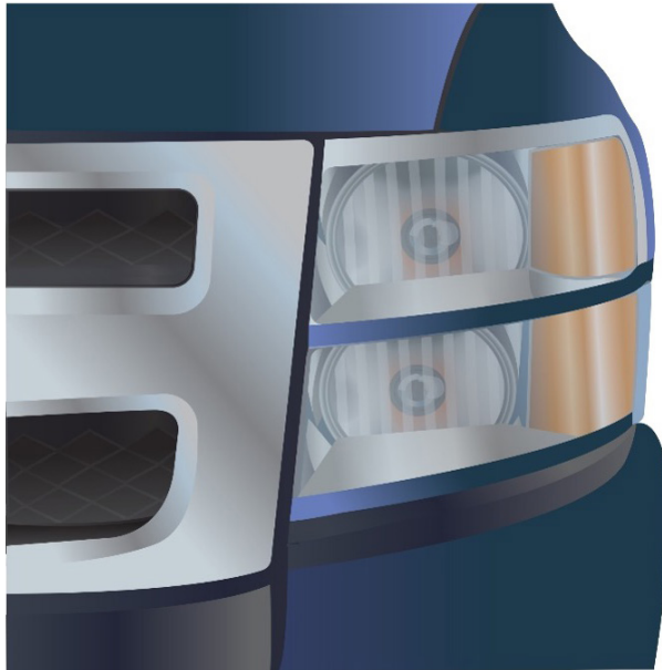
Figura 2. Faro delantero de una pieza de la camioneta GMT 900
