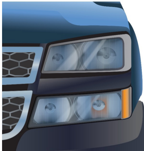
Figura 1. Faro delantero de dos piezas de la camioneta GMT 800 “Classic”. El diseño dividido es una característica de identificación única
