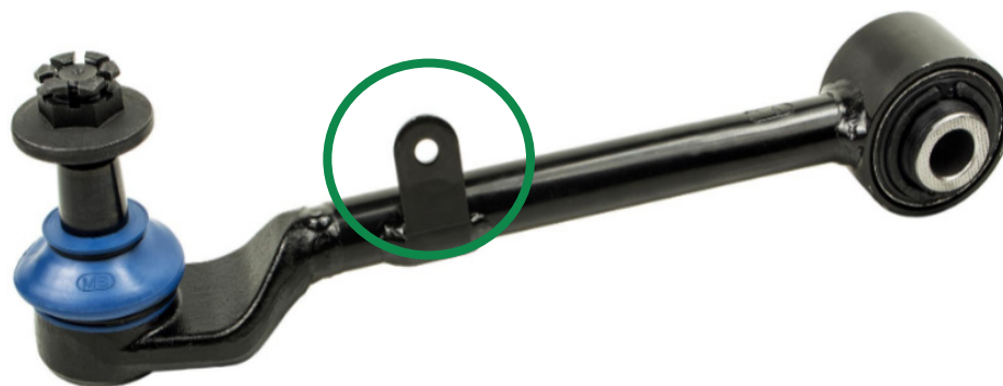
Figura 1. El CMS601029 y el CMS601030 presentan una pestaña de montaje para los sensores de altura de conducción en vehículos equipados con ADS. Esta pestaña puede ignorarse cuando el brazo de control se instala en modelos de suspensión básica.
