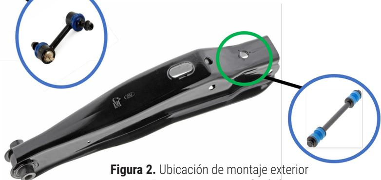
**Figura 2.** Ubicación de montaje exterior en CMS501232 para conexión de barra estabilizadora estilo 2
