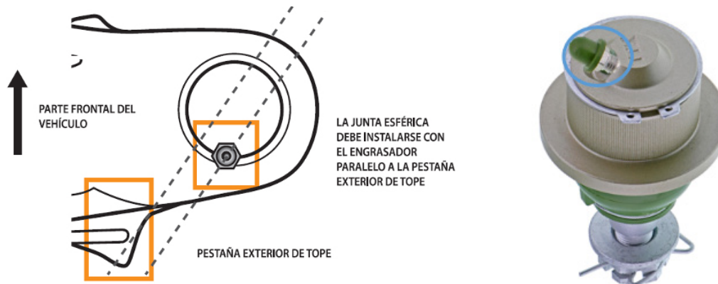
Figura 1. Para asegurar el espacio libre adecuado entre los componentes y la accesibilidad para futuros servicios de lubricación, la junta esférica debe instalarse con el conector de grasa en paralelo a la pestaña de tope del brazo de control delantero inferior
