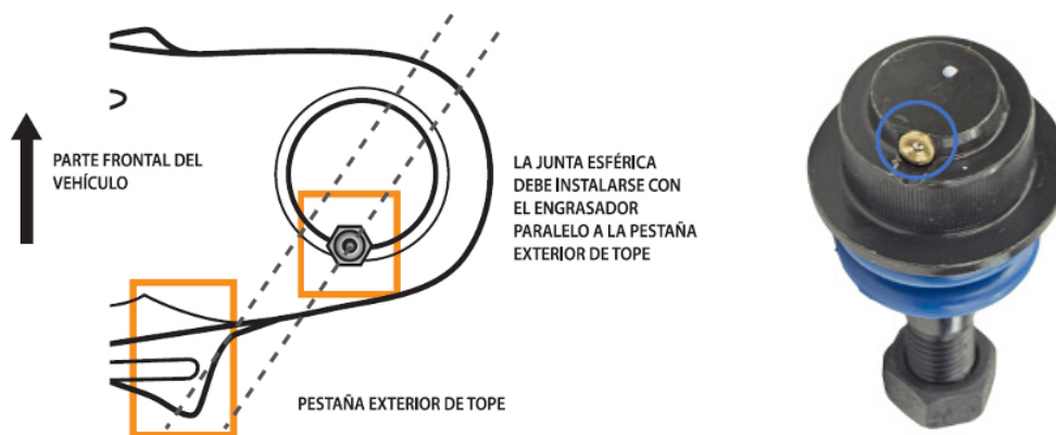
Figura 1. Para asegurar el espacio libre adecuado entre los componentes y la accesibilidad para futuros servicios de lubricación, la junta esférica debe instalarse con el conector de grasa en paralelo a la pestaña de tope del brazo de control delantero inferior
