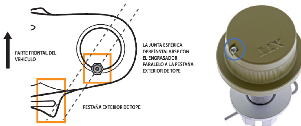
Figura 1. Para asegurar el espacio libre adecuado entre los componentes, la junta esférica debe instalarse con el conector de grasa en paralelo a la pestaña exterior de tope inferior
