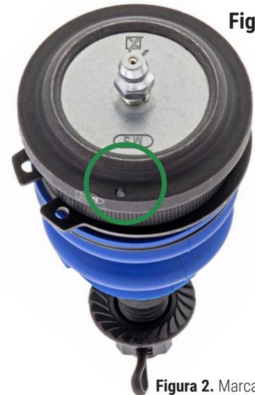
**Figura 2.** Marca de referencia perforada en una brida de la junta esférica (dentro del círculo)
