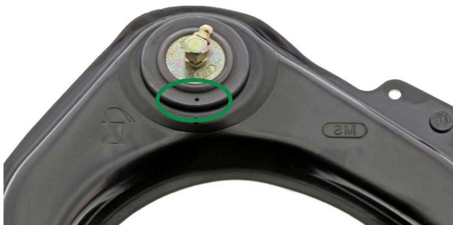
Figura 2. Marca de indicación del brazo de control. En este ejemplo, la marca de indicación es un orificio.
