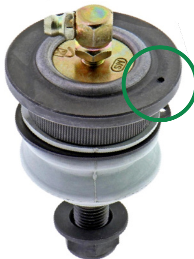
Figura 1. Marca de indicación de la junta esférica. En este ejemplo, la marca de indicación es un orificio.
