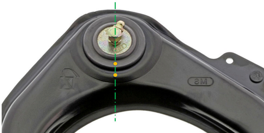
Figura 3. La orientación correcta de la instalación se logra cuando la marca de indicación de la junta esférica se alinea con la marca de indicación del lado del brazo de control.
