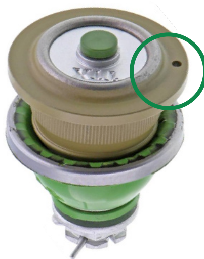
Figura 1. Marca de indicación de la junta esférica. En este ejemplo, la marca de indicación es un orificio.
