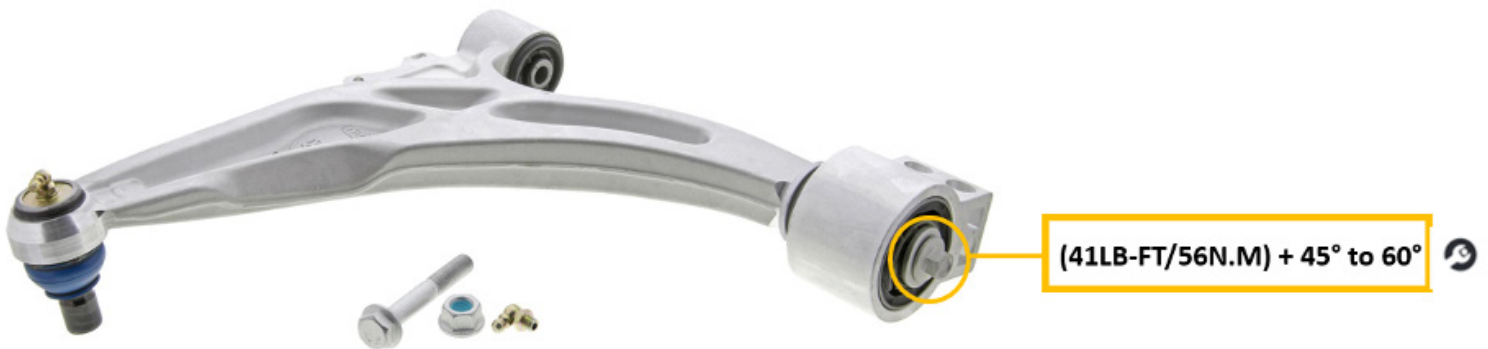
Figura 1. El perno del soporte del buje (encerrado en un círculo arriba) debe apretarse correctamente después de colocar el brazo de control en el vehículo
