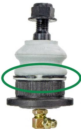
**Figura 1.** El anillo de ajuste está colocado en forma segura en el protector. El anillo de ajuste y el protector están colocados correctamente en la ranura maquinada de la carcasa.
