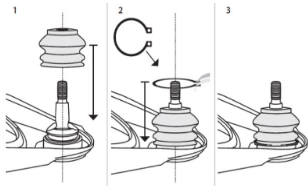
**Figura 2.** Ilustración que muestra el procedimiento de instalación correcta del protector.
