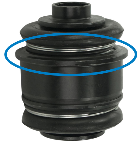
Figura 2. Asegúrese de que el reborde (dentro del círculo) esté orientado correctamente durante la presión
