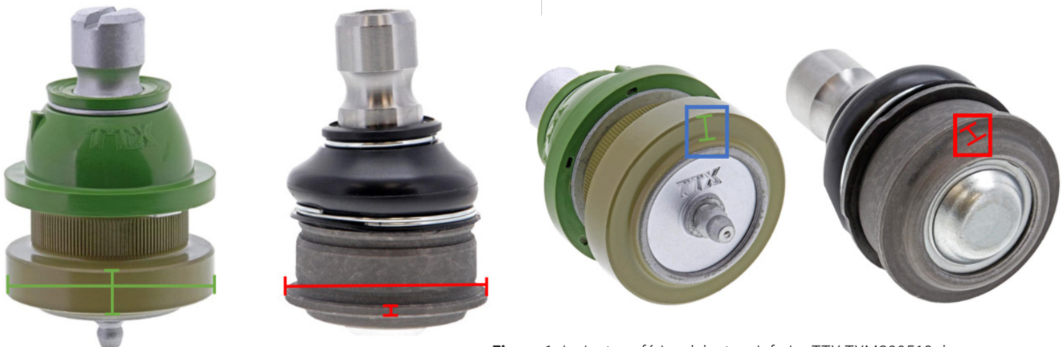
Figura 1. La junta esférica delantera inferior TTX TXMS30512 de Mevotech está diseñada con una brida con un diámetro mayor y con mayor grosor, y con una carcasa rugosa
