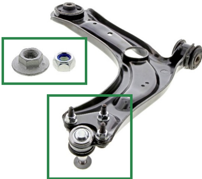
Figura 1. Conjunto del brazo de control delantero inferior Supreme de Mevotech CMS701166 con junta esférica preajustada y hardware (izquierda) vs brazo de control simple de fabricante de equipo original (derecha)
