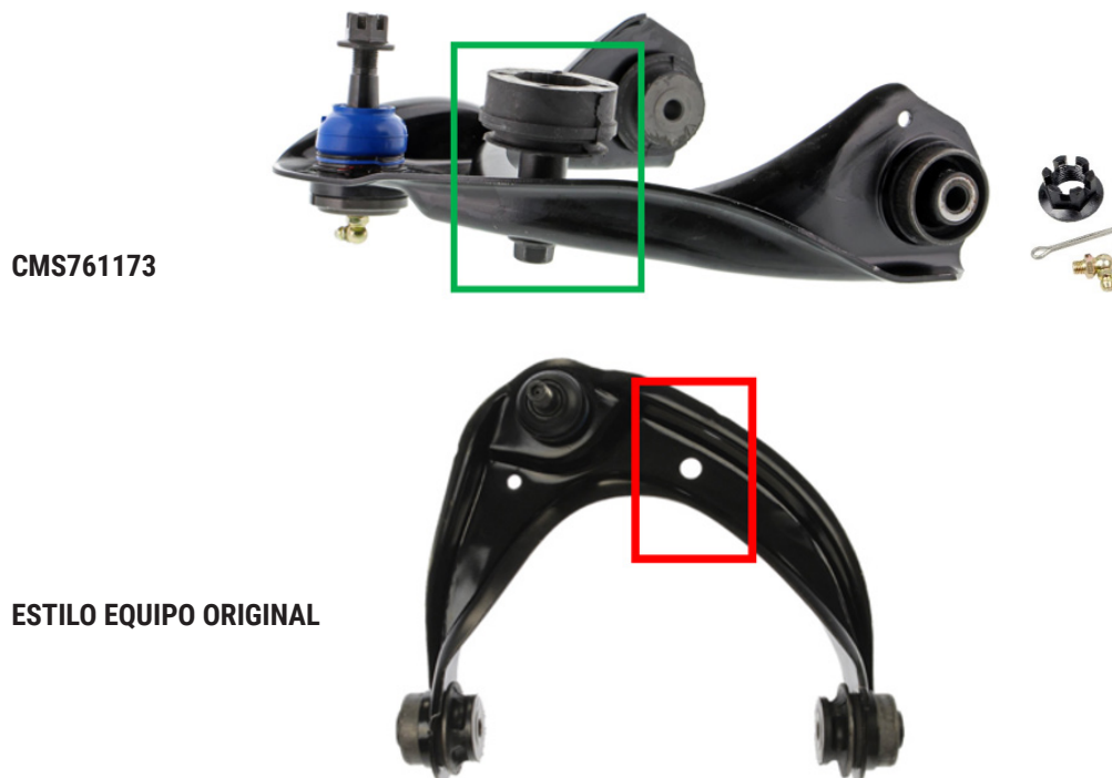
Figura 1. El brazo de control delantero superior CMS761173 Supreme de Mevotech cuenta con un tope del brazo de control preinstalado (arriba) vs brazo de control de estilo de fabricante original (abajo)
