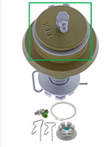
Figura 1. La junta esférica delantera inferior TTX de Mevotech TXK6541 puede asegurarse al brazo de control fácilmente mediante el anillo de ajuste incluido (izquierda) vs método de fijación con estacas/engarzado del fabricante de equipo original (derecha)
