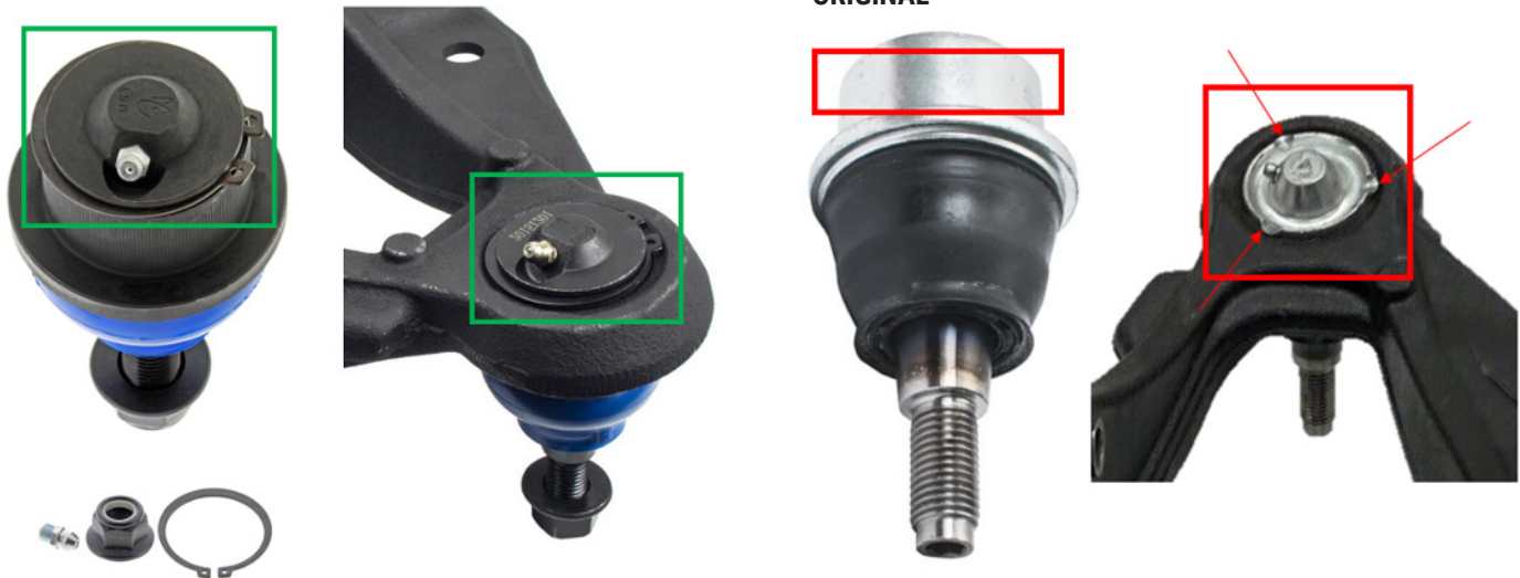
Figura 1. La junta esférica delantera inferior Supreme de Mevotech MS50553 puede asegurarse al brazo de control fácilmente mediante el anillo de ajuste incluido (izquierda) vs método de fijación con estacas/engarzado del fabricante de equipo original (derecha)
