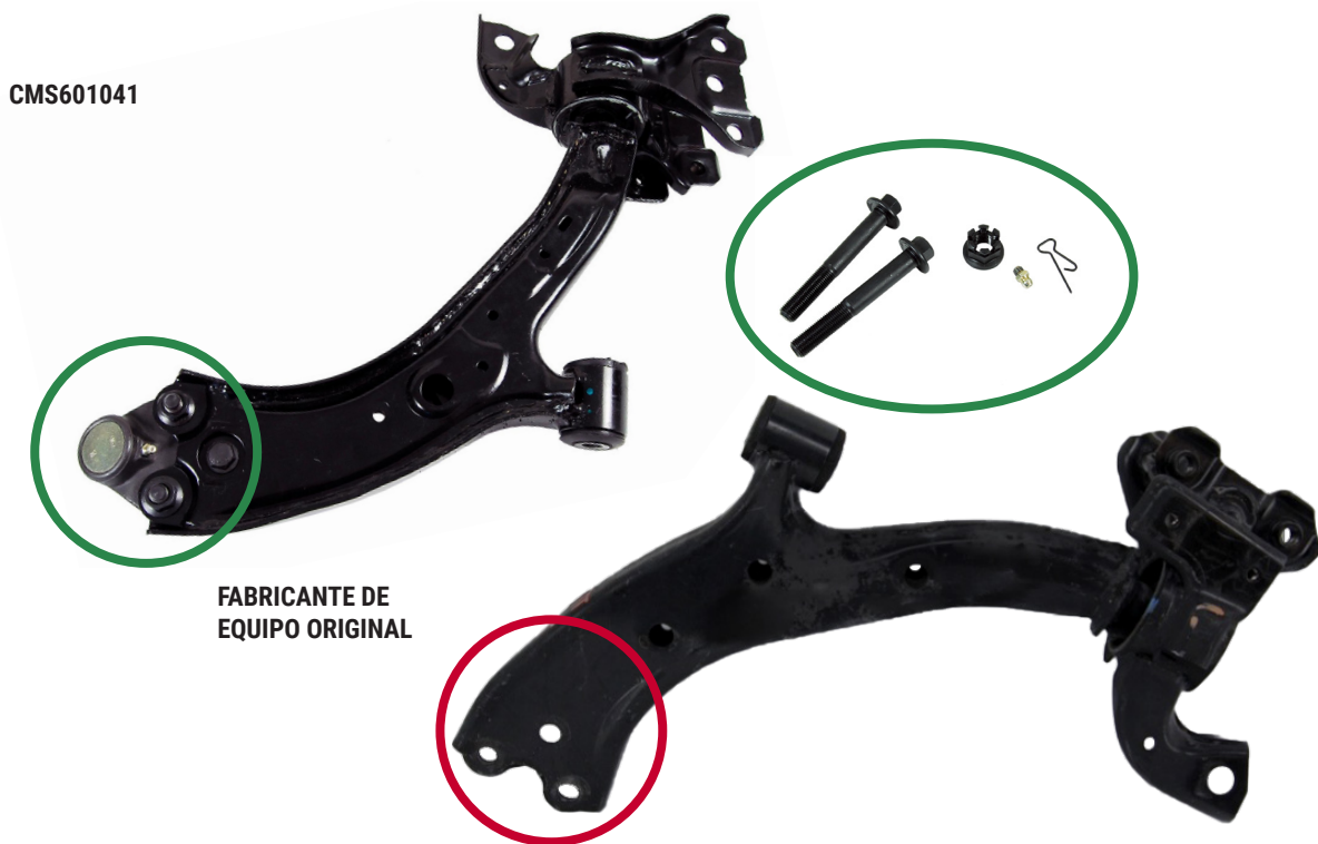
Figura 1. Brazo de control delantero inferior hacia adelante Supreme de Mevotech CMS601041 con junta esférica preinstalada y hardware (arriba) vs brazo de control básico estilo equipo original (abajo)
