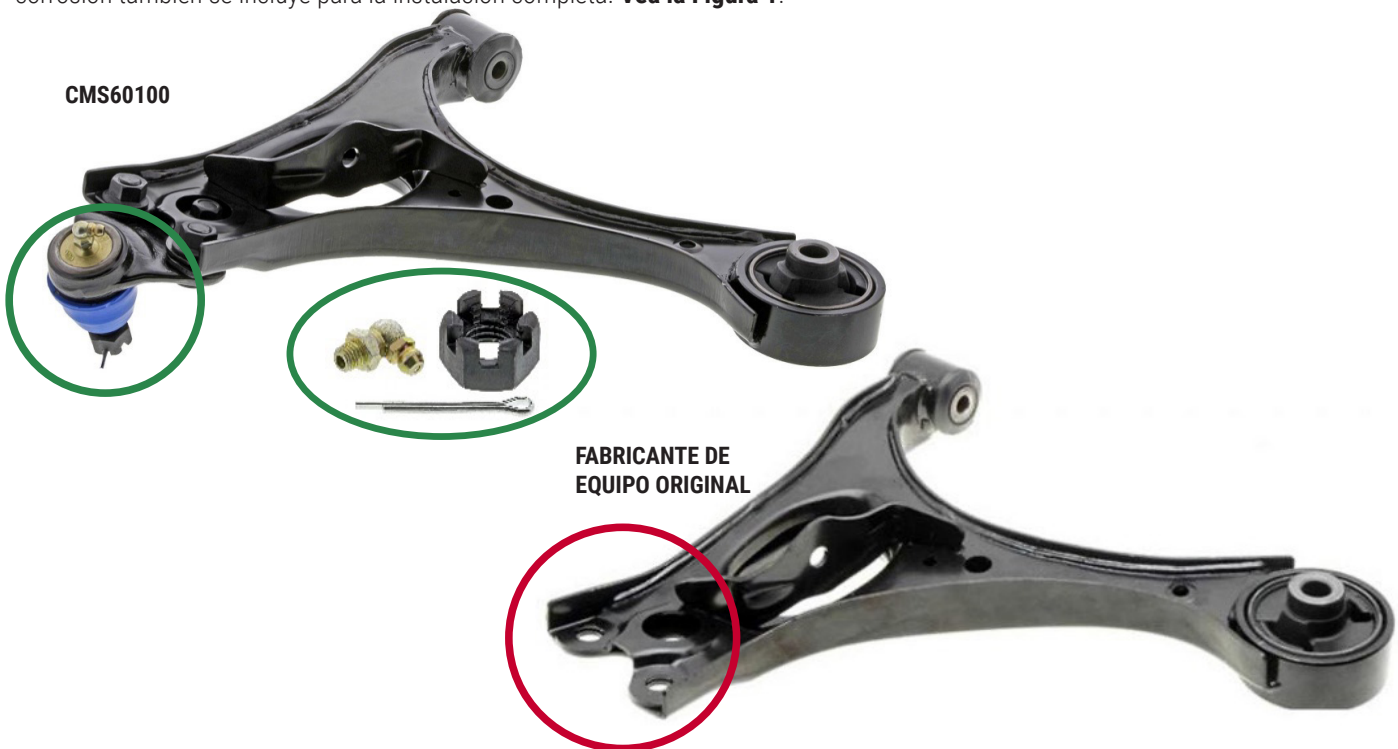
Figura 1. Conjunto del brazo de control delantero inferior Supreme de Mevotech CMS60100 con junta esférica de rodamientos sinterizados engrasables autolubricantes preinstalada y hardware (arriba) vs brazo de control simple de fabricante de equipo original (abajo)
