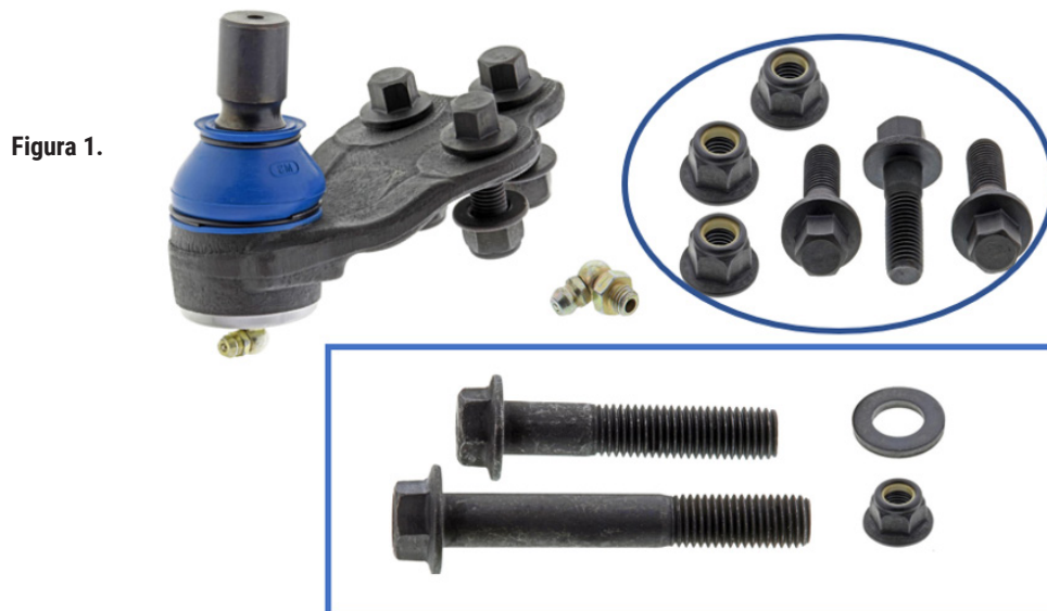
Figura 1. Junta esférica delantera inferior Supreme de Mevotech MS25548 con kit de hardware completo, incluyendo pernos de prensión, arandela y tuerca para el muñón de dirección (dentro del cuadro resaltado) y pernos y tuercas para el brazo de control (dentro del círculo)
