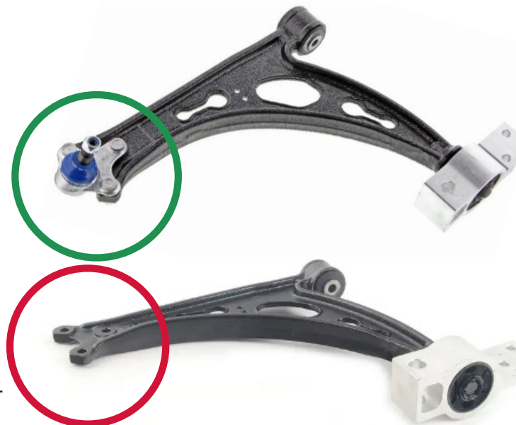
Figura 1. Conjunto del brazo de control Supreme de Mevotech con junta esférica preinstalada y hardware (arriba) vs conjunto del brazo de control básico estilo equipo original (abajo)
