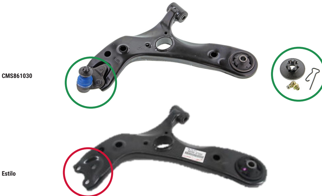
Figura 1. Conjunto del brazo de control Supreme de Mevotech con junta esférica preinstalada y hardware (arriba) vs brazo de control básico estilo equipo original (abajo)
