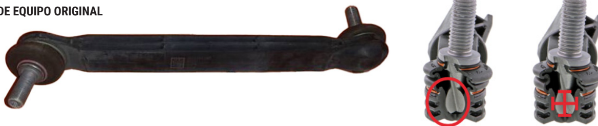
Figura 1. Supreme de Mevotech MS258135 con diseño de acero sólido y rodamientos de metal sinterizado superior e inferior, engrasables, autolubricantes, perno esférico más grande para el área de contacto con el rodamiento y hardware incluido (arriba) vs cuerpo de plástico del fabricante de equipo original, carcasa de plástico sellada y área de contacto del perno esférico reducida (abajo)
