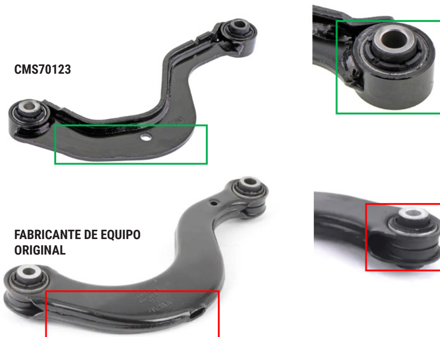
Figura 1. El brazo de control trasero superior Supreme de Mevotech CMS70123 cuenta con una fabricación forjada sólida con retención mejorada de buje (arriba) vs diseño de fabricante de equipo original (abajo)
