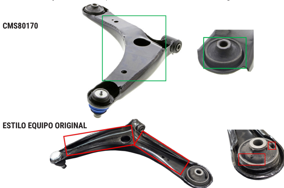
Figura 1. El brazo de control delantero inferior Supreme de Mevotech CMS80170 cuenta con un perfil estampado mejorado con una placa de refuerzo y huecos rellenos (arriba) vs diseño de equipo estilo fabricante original (abajo)
