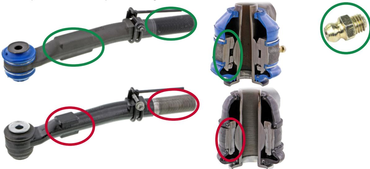
Figura 1. Extremo de la barra de acoplamiento externa derecha delantera Supreme de Mevotech MS40672 con perfil forjado mejorado, rodamientos de metal sinterizado superior e inferior engrasables autolubricantes, recubrimiento anticorrosivo y hardware incluido (arriba) vs fabricante de equipo original con rodamiento de plástico sellado, perfil forjado reducido y acabado sin recubrimiento en el extremo roscado (abajo)
