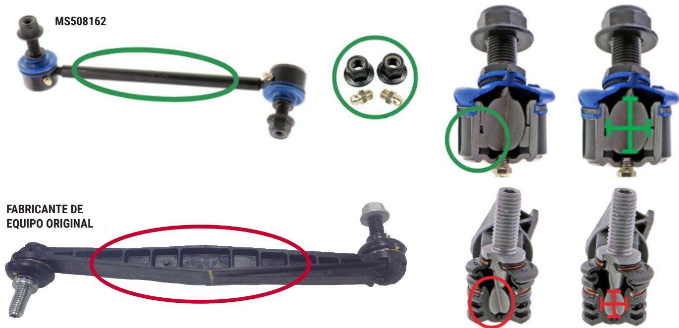
Figura 1. Supreme de Mevotech MS508162 con diseño de acero sólido y rodamientos de metal sinterizado superior e inferior, engrasables, autolubricantes, perno esférico más grande para el área de contacto con el rodamiento y hardware incluido (arriba) vs cuerpo de plástico del fabricante de equipo original, carcasa de plástico sellada y área de contacto del perno esférico reducida (abajo)
