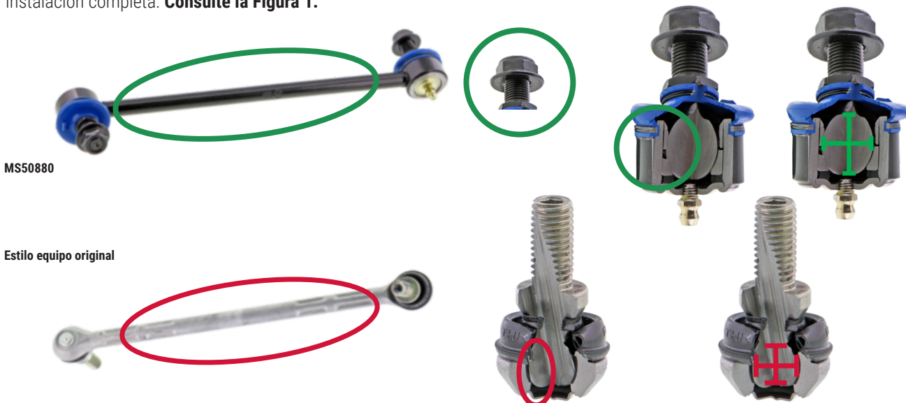
Figura 1. Barra estabilizadora delantera Supreme de Mevotech MS50880 con construcción de acero sólido y rodamiento de metal sinterizado inferior, engrasable, autolubricante, perno esférico más grande para el área de contacto con el rodamiento y hardware incluido (arriba) vs fabricante de equipo original con rodamiento sellado de plástico, cuerpo de aluminio ligero y área de contacto del perno esférico reducida (abajo)
