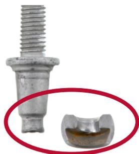
**Figura 1.** Barra de conexión estabilizadora Supreme de Mevotech MS50839 con diseño de acero sólido y rodamientos de metal sinterizado superior e inferior engrasables autolubricantes, perno esférico sólido de 1 pieza y hardware incluido (arriba) vs rodamiento de plástico sellado, cuerpo de plástico de fabricante de equipo original y perno esférico de 2 piezas (abajo)
