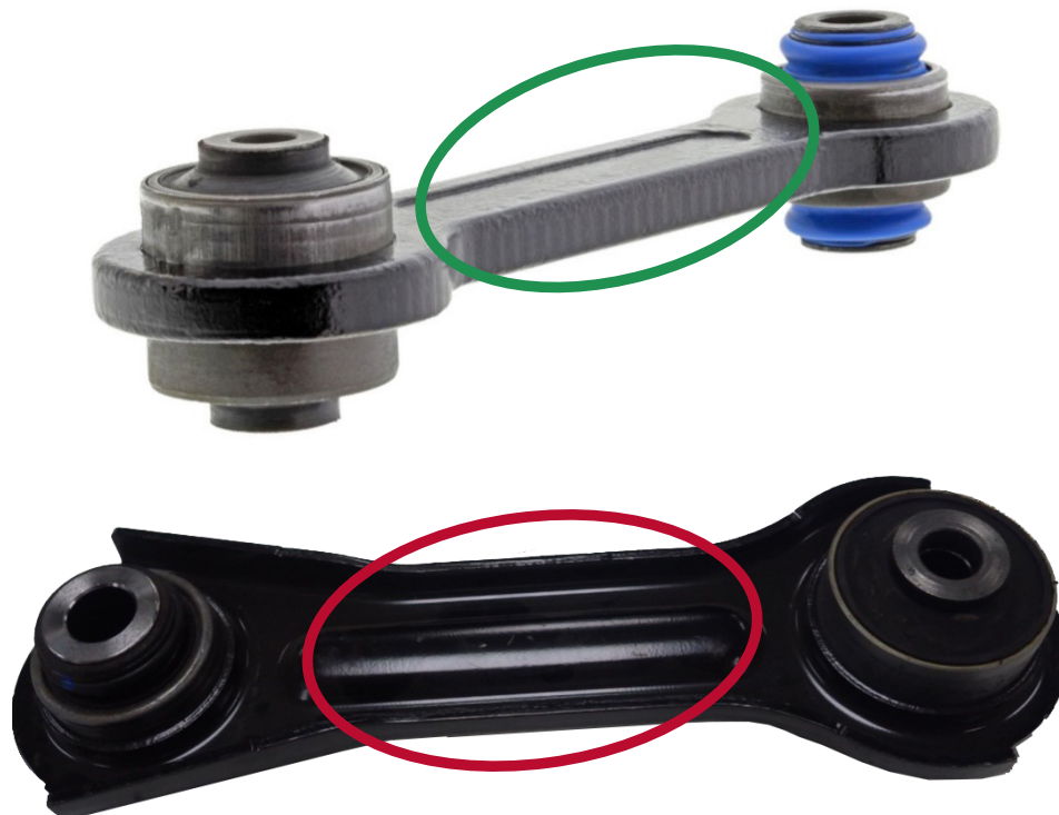
Figura 1. Brazo lateral Supreme de Mevotech CMS251251 con perfil forjado sólido actualizado (arriba) vs diseño de acero estampado más delgado de fabricante de equipo original (abajo)
