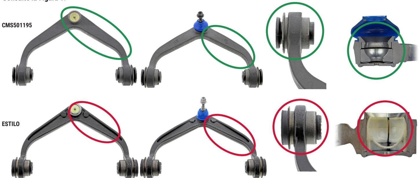
Figura 1. Brazo de control Supreme de Mevotech con rodamientos de metal sinterizado autolubrificantes engrasables y perfil forjado mejorado (arriba) vs brazo de control estilo equipo original (abajo)
