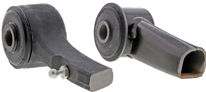
Figura 1 : Diseño forjado sólido de Mevotech (izquierda) vs acero estampado hueco de equipo original (derecha)
