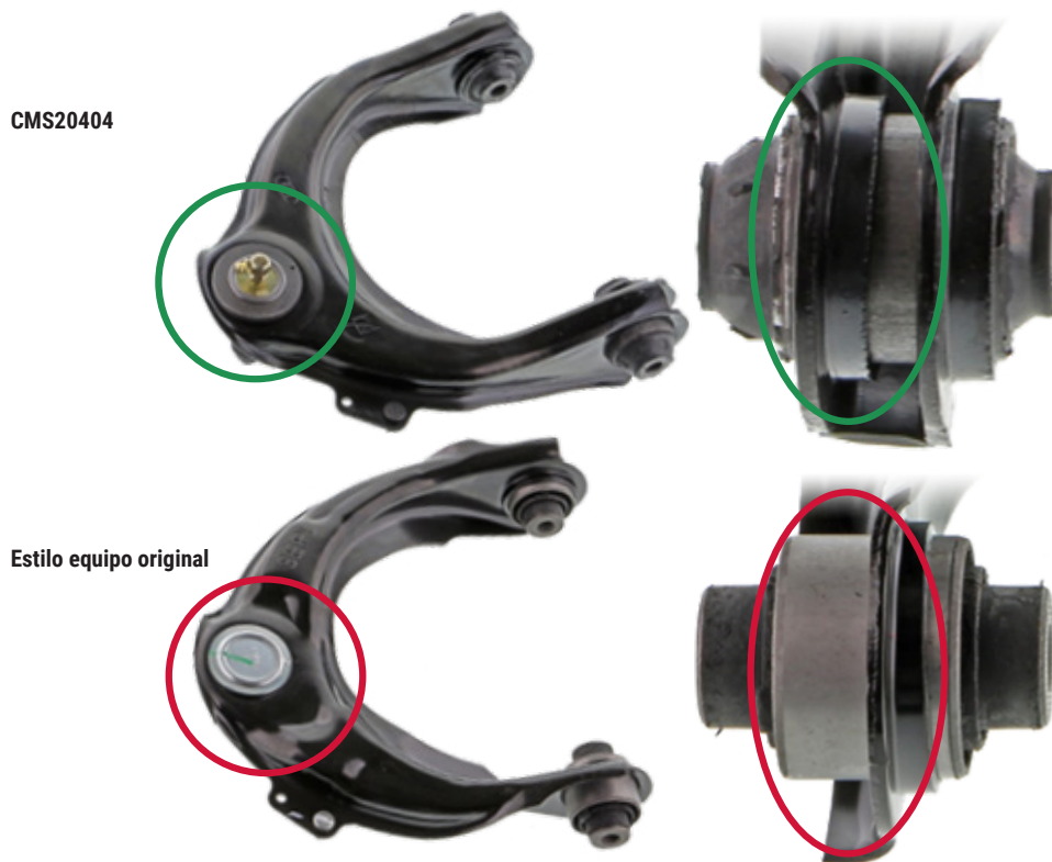
Figura 1. Brazo de control Supreme de Mevotech con rodamientos de metal sinterizado engrasables, estampado mejorado y perfil de buje (arriba) vs brazo de control estilo equipo original (abajo)
