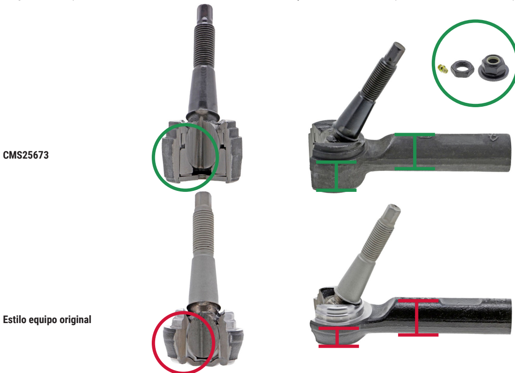
Figura 1. Extremo de la barra de acoplamiento externa Supreme de Mevotech MS25673 con perfil forjado mejorado que presenta rodamientos superior e inferior de metal sinterizado engrasables autolubricantes e incluye hardware (arriba) vs diseño de fabricante de equipo original (abajo)
