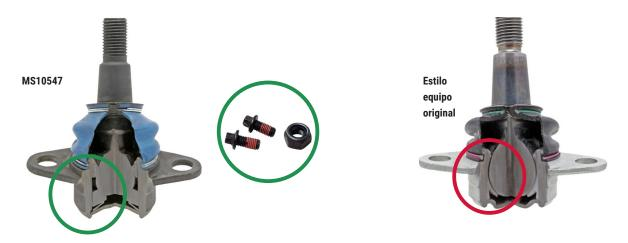
Figura 1. MS10547 Supreme de Mevotech con rodamientos de plástico superior e inferior de metal sinterizado autolubricantes y hardware incluido (izquierda) vs junta esférica estilo equipo original con rodamiento de plástico y componentes sin recubrimiento (derecha)
