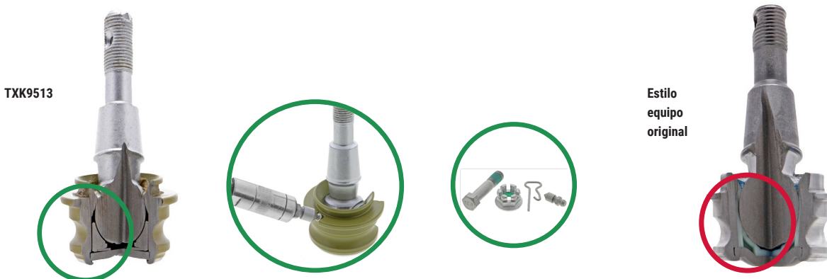
Figura 1. TXK9513 TTX de Mevotech con rodamientos de metal sinterizado autolubricantes engrasables, conector de grasa integrado y hardware incluido (izquierda) vs junta esférica de fabricante de equipo original con rodamiento de plástico sellado (derecha)
