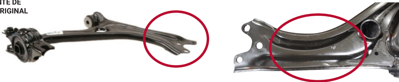
Figura 1. Brazo de control Supreme de Mevotech CMS601239 con perfil estampado mejorado, placa de refuerzo y hardware incluido (arriba) vs diseño de fabricante de equipo original (abajo)
